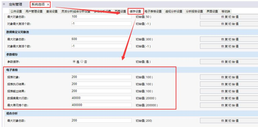
V95版本打开,“系统运维-》系统选项”,导航到“缓存”Tab页,在其下的“电子表格”段设置“数据集最大行数”、“最大单元格个数”两个属性。
